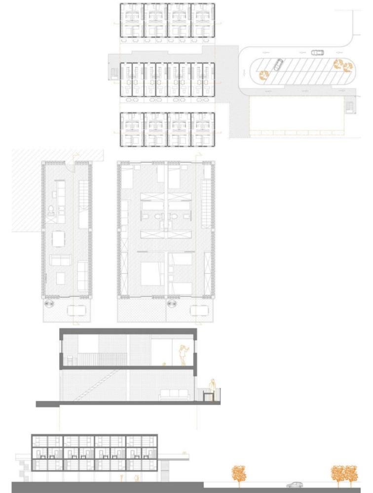
La Posta Sanitaria se plantea como un proyecto capaz de ser montado y desmontado en cualquier momento, basada en una modulación que se va repitiendo y desplazando hasta generar lo que es la propia Posta Sanitaria, pero esta **modulación no es arbitraria**, ya que responde a unas dimensiones impuestas.
